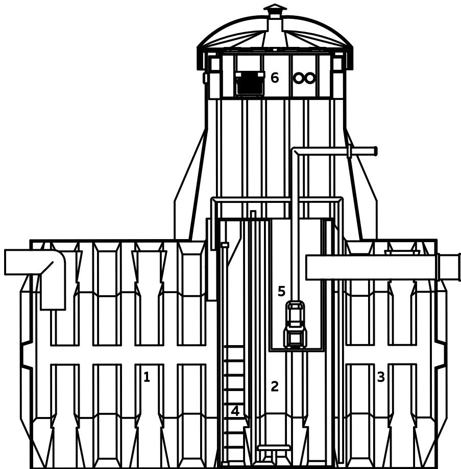
1. Приемная камера, 2. Аэротэнк, 3. Камера гравитационного осаждения активного ила, 4. Волосоуловитель, 5. Блок-успокоитель очищенной воды, 6. Блок управления
